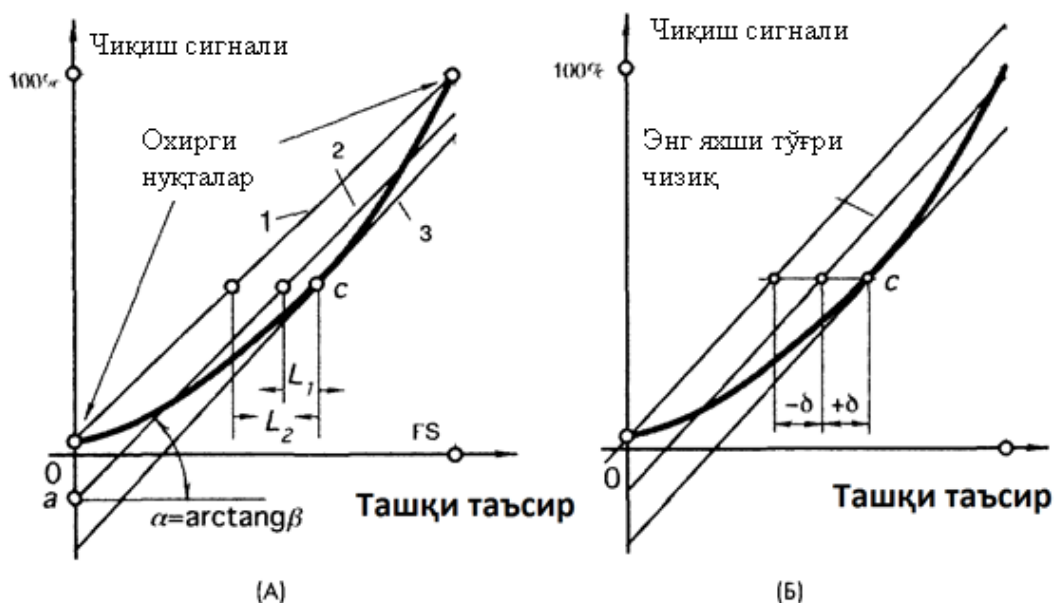
1-расм. Ночизикли узатиш функциясини чизикли аппроксимациялаш (А) ва мустақил чизиклаштириш (Б).
