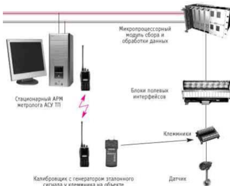
Рис 1. Существующая методика калибровки ИК Автоматизированная методика калибровки
