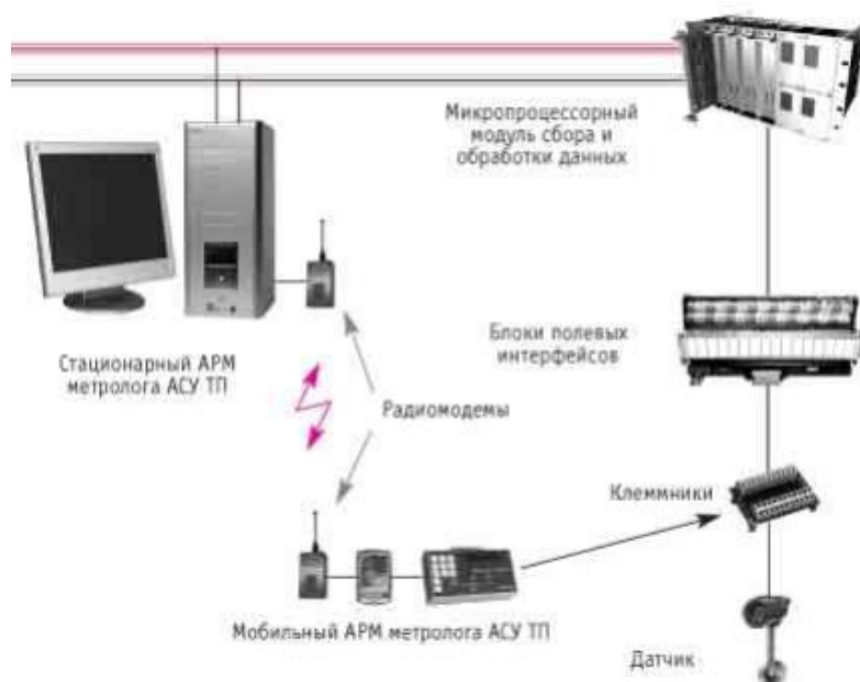
Рис. 2. Методика автоматизированной калибровки ИК АСУ ТП
